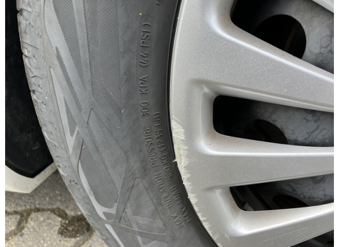
Felge (Sommer-Radsatz) - Vorderachse rechts - Radblende beschädigt - erneuern
