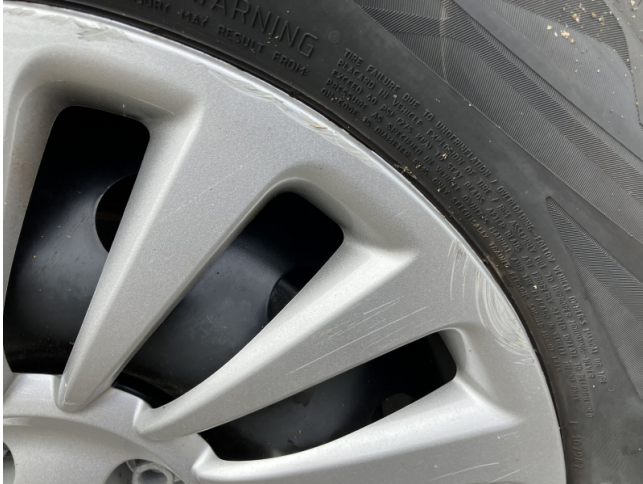
Felge (Sommer-Radsatz) - Vorderachse rechts - Radblende beschädigt - erneuern
