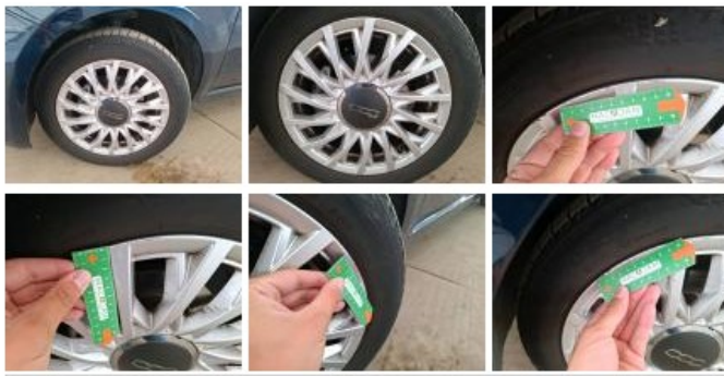
Pneu AVG, Déchirure, E - Remplacer
