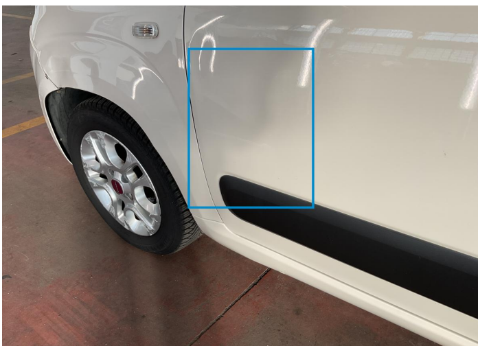
14. Door / Front Left Bodywork / Dent -
