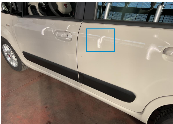
15. Door / Back Left Bodywork / Dent -
