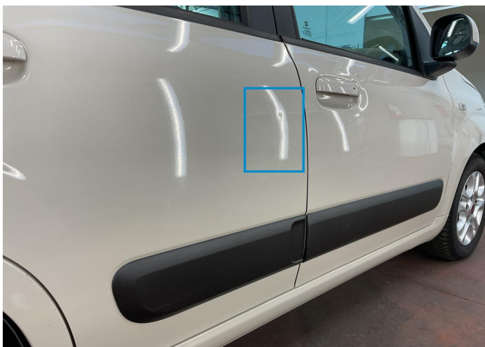
25. Door / Back Right Bodywork / Dent -
