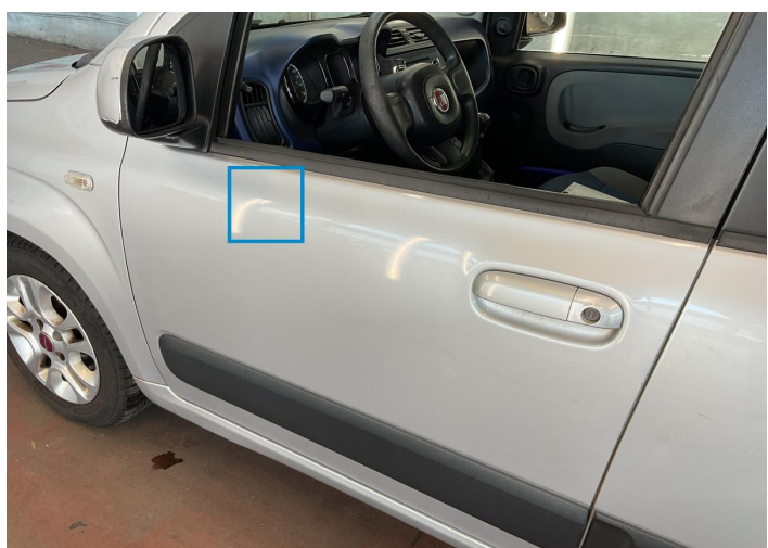
17. Door / Front Left Bodywork / Dent -
