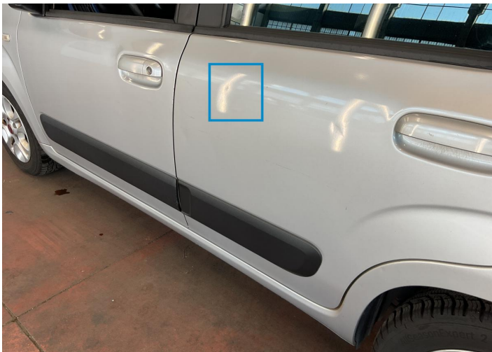
19. Door / Back Left Bodywork / Dent -
