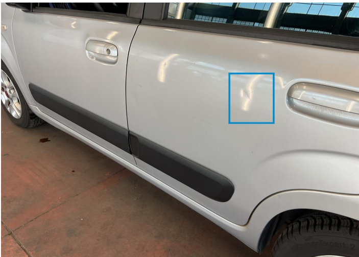
20. Door / Back Left Bodywork / Dent -
