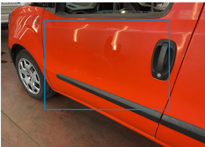
13. Door / Front Left Bodywork / Dent -
