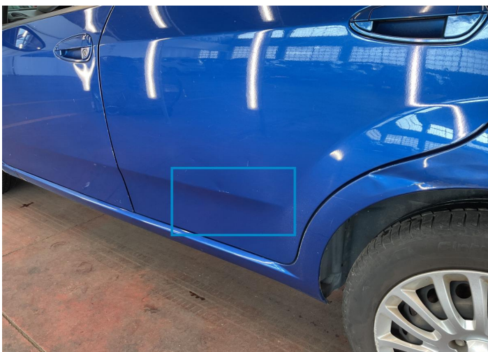
12. Door / Back Left Bodywork / Dent -
