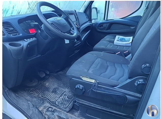
5. Stoelbekleding Beschadigd - Vernieuwen
