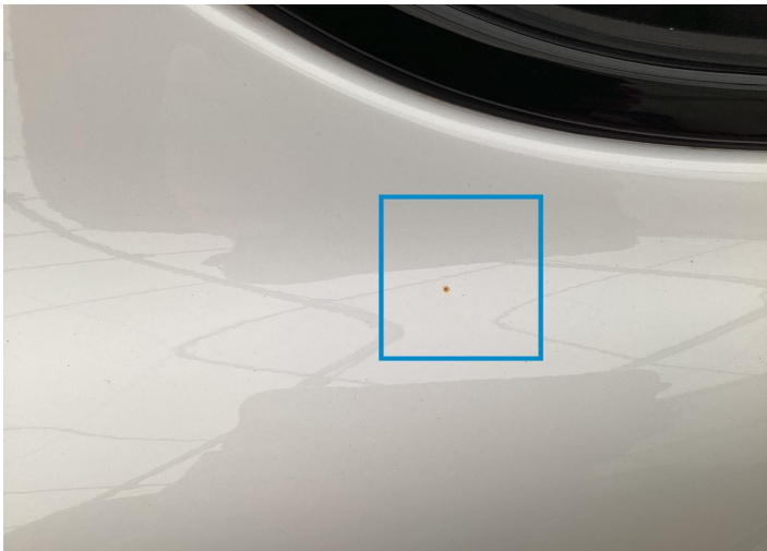
17. Door / Back Right Paint / Corrosion -
