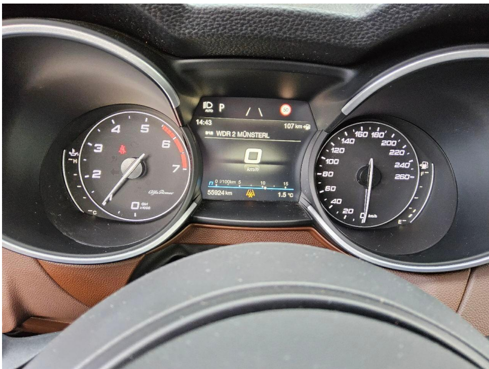
Bild 4 : Kombiinstrument (betriebsbereit) mit Km-Stand
