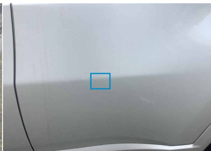
6. Door / Back Left Paint / Chipping -
