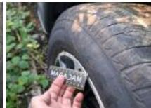
Jante alum. ARD bi-ton/polychrome, Déformé / Forcé, E - Remplacer
