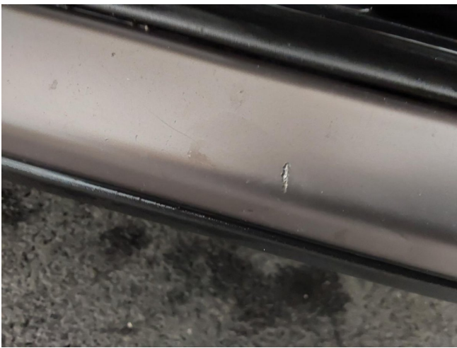
Stoßfänger Vorne Zierleiste Kratzer - ersetzen
