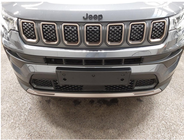
Stoßfänger Vorne Zierleiste Kratzer - ersetzen
