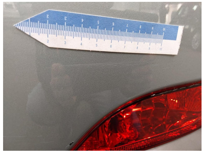
Stoßfänger Hinten Kratzer - Smart Repair
