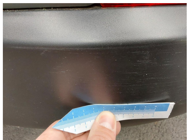
Stoßfänger Verkleidung Hinten Kratzer - ersetzen
