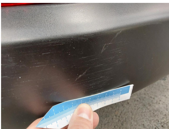
Stoßfänger Verkleidung Hinten Kratzer - ersetzen
