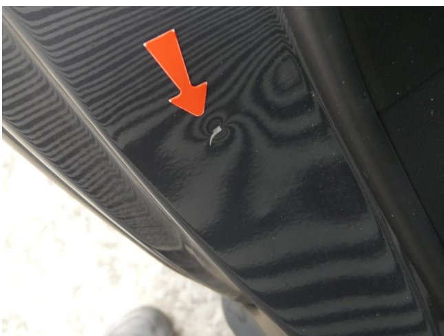
Tür hinten rechts - Einstieg-Kratzer-Smart Repair
