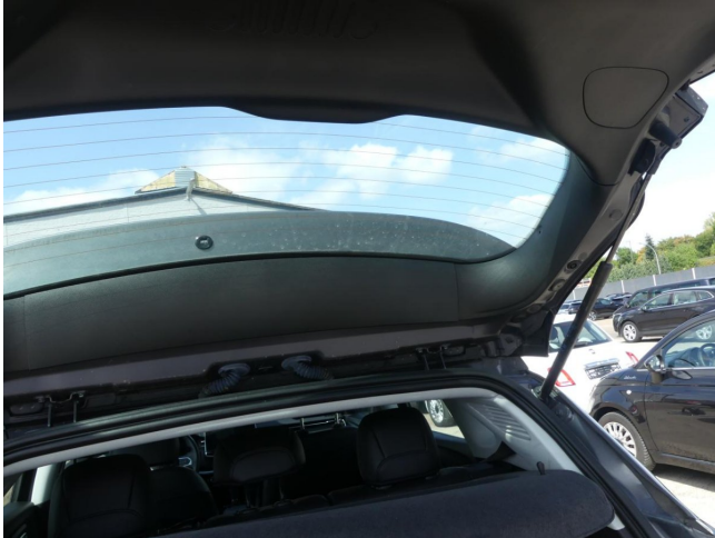
Laderaumabdeckung Befestigung gebrochen - erneuern
