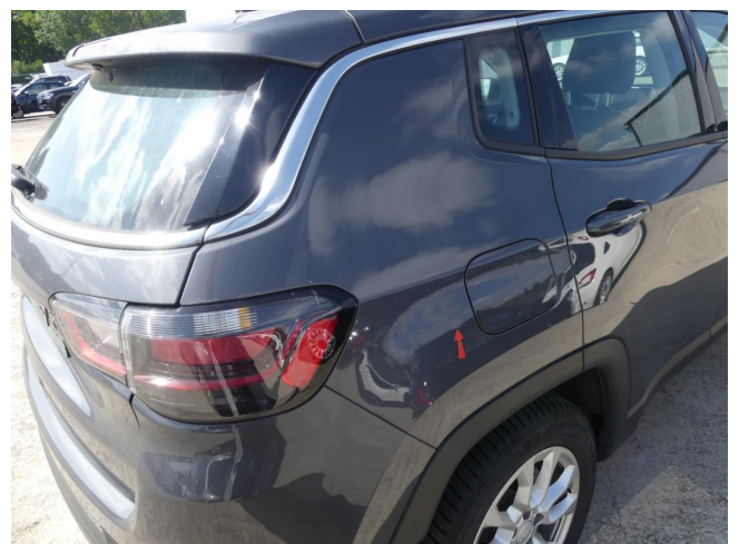
Fondseite rechts - Dellen - entfernen
