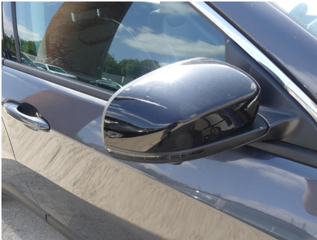
Außenspiegelgehäuse rechts - Spiegelkappe zerkratzt - lackieren
