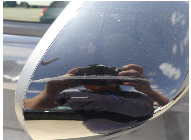
Außenspiegelgehäuse rechts - Spiegelkappe zerkratzt - lackieren
