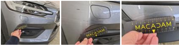
Moulure de pare-chocs AV, Griffe(s), E - Remplacer
