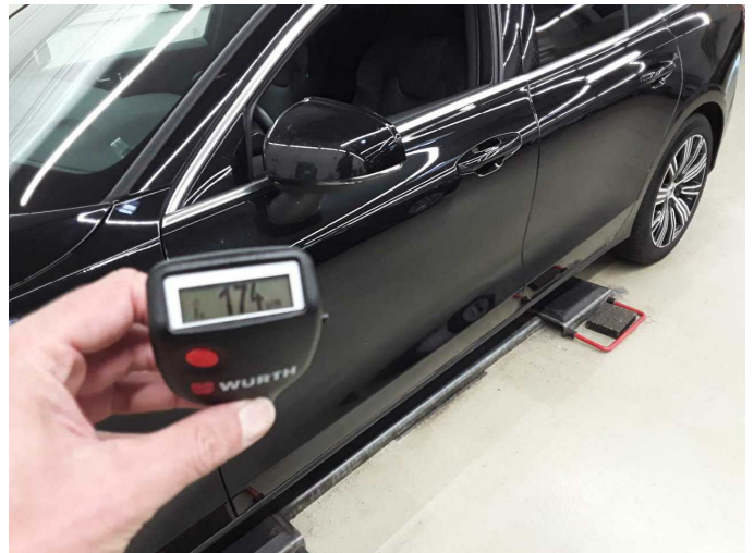
Door - front left side: 174 µm
