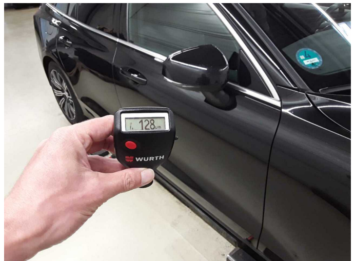
Door - front right side: 128 µm
