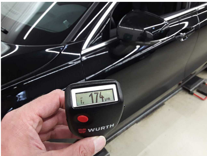
Door - front left side: 174 µm
