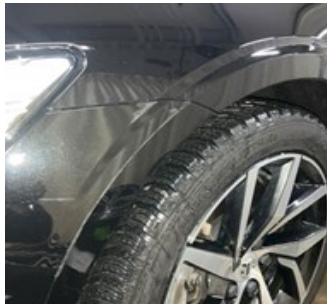
7.4.1 - Stötfångare fram :: Punktbättring 0-10+ spackling
