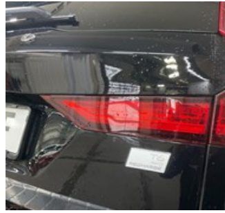
3B.2 - Bakljus VB HB Fukt höger inre
