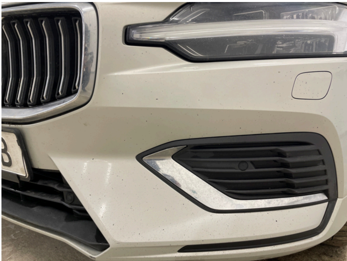
Stötfångare Fram Stenskott flertal 800 kr
