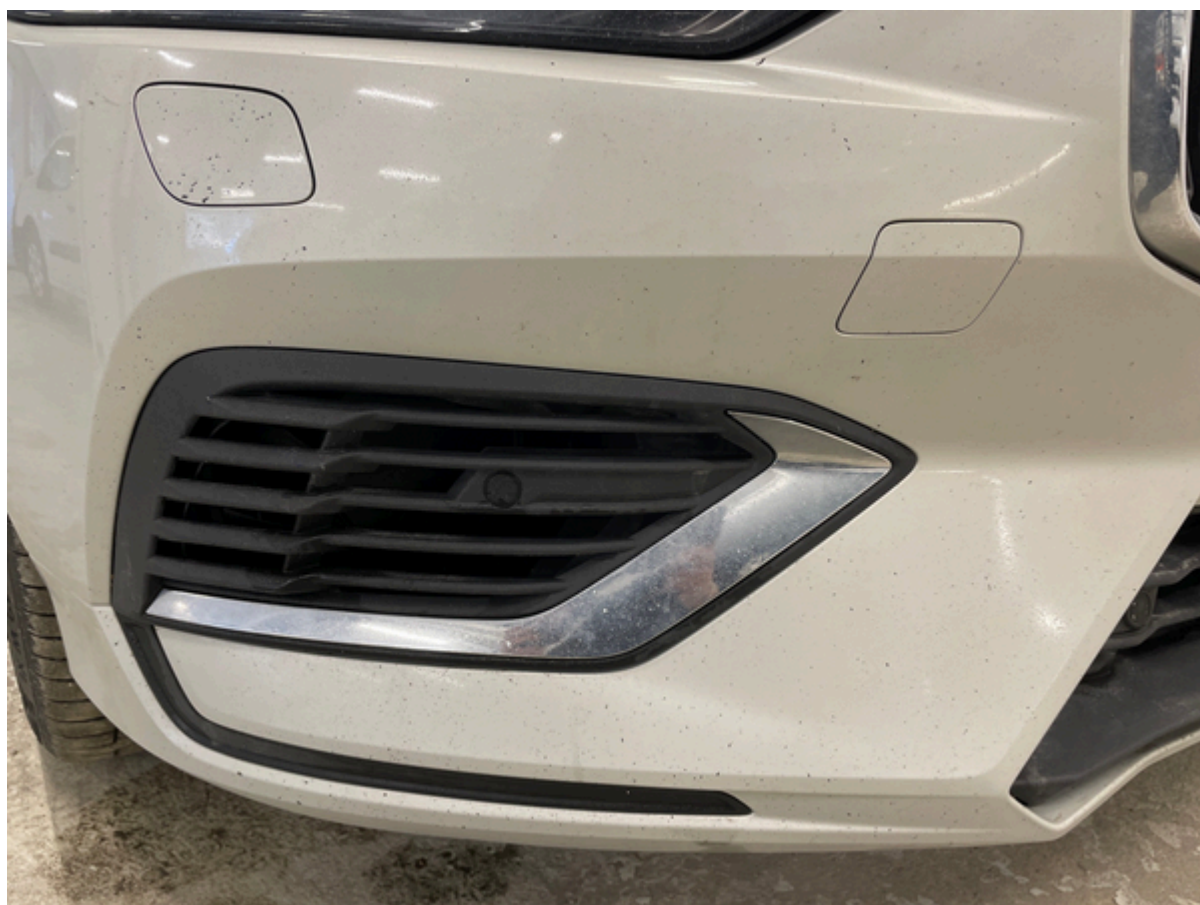
Stötfångare Fram Stenskott flertal 800 kr
