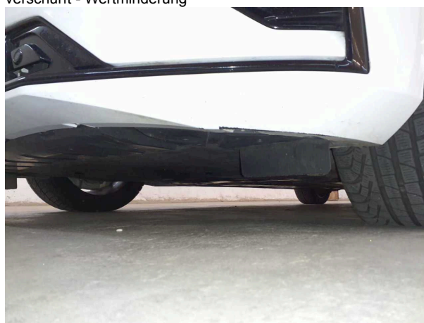
Beschädigung #9: Stossfänger vorn: Stossfänger vorn - verkratzt / verschürft - Smart Repair
