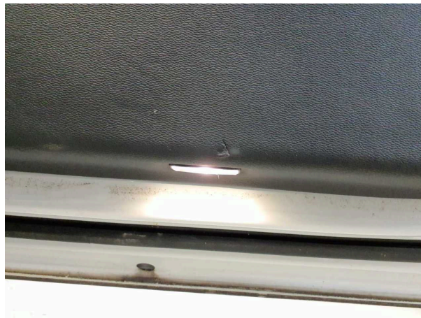
Beschädigung #7: Verkleidungen/Abdeckungen: Türverkleidung vorn rechts - beschädigt - Wertminderung
