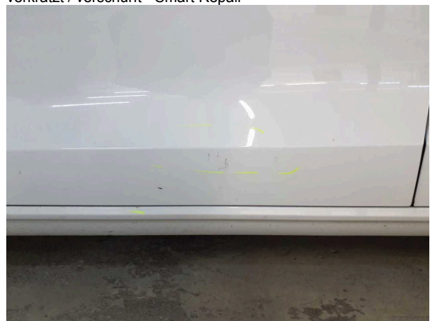
Beschädigung #10: Tür vorn links: Tür - verkratzt / verschürft - Smart Repair
