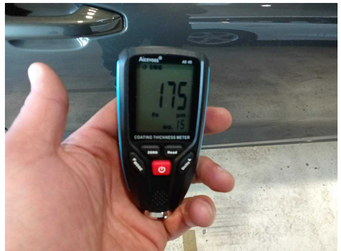
Door - front right side: 175 µm
