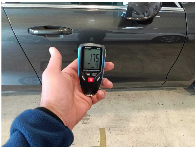
Door - front right side: 175 µm
