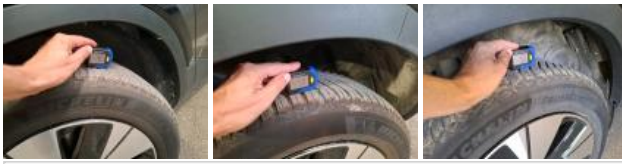
Pneu AVD, Hors tolérance, E - Remplacer
