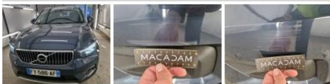
Joint de coffre, Déchirure, E - Remplacer
