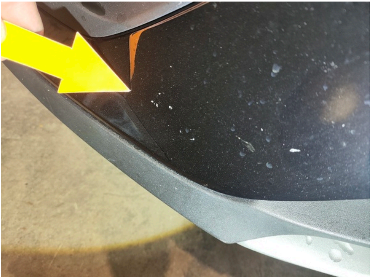
Stötfångare Fram Stenskott flertal 800 kr
