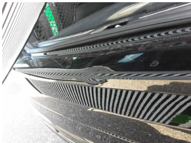
Beschädigung #9: Stossfänger hinten: Stossfänger hinten - verformt - erneuern
