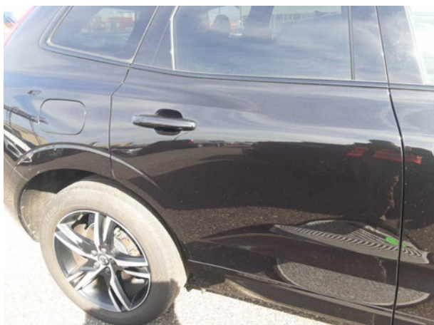
Beschädigung #3: Tür hinten rechts: Tür - Delle(n) - Smart Repair
