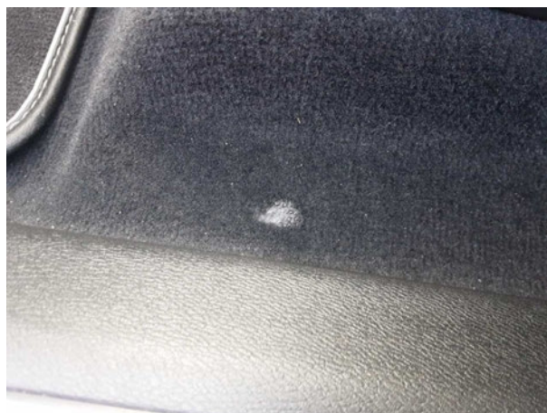
Beschädigung #4: Verkleidungen/Abdeckungen: Teppichboden vorn links - Brandloch - Smart Repair
