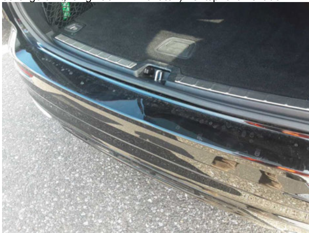
Beschädigung #9: Stossfänger hinten: Stossfänger hinten - verformt - erneuern
