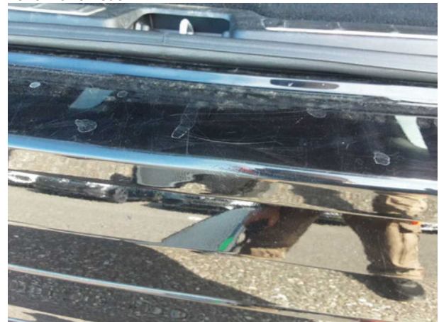
Beschädigung #9: Stossfänger hinten: Stossfänger hinten - verformt - erneuern
