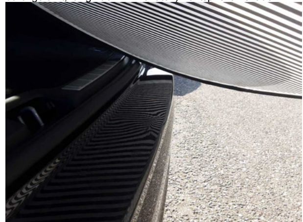
Beschädigung #9: Stossfänger hinten: Stossfänger hinten - verformt - erneuern
