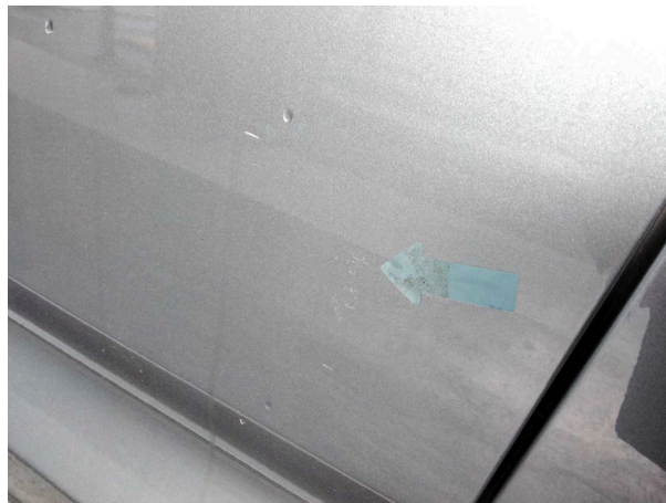
Beschädigung #9: Tür vorn links: Tür - verkratzt / verschürft - Smart Repair
