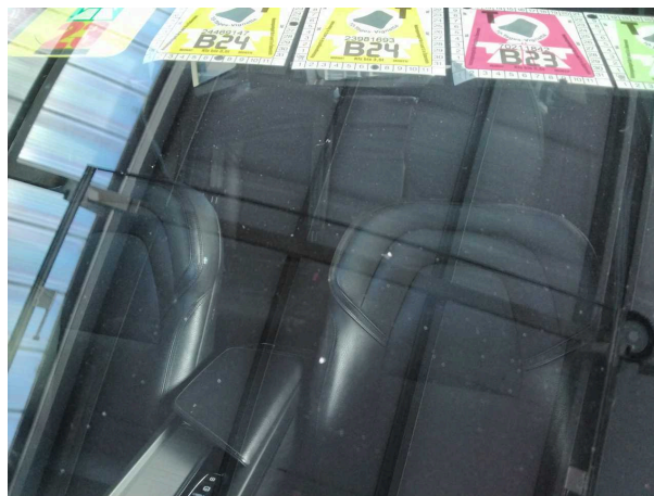
Beschädigung #11: Verglasung: Frontscheibe - Steinschlag - erneuern
