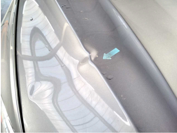
Beschädigung #13: Motorhaube: Motorhaube - verformt - erneuern
