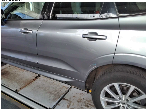
Beschädigung #12: Tür hinten links: Tür - verformt - instandsetzen und lackieren
