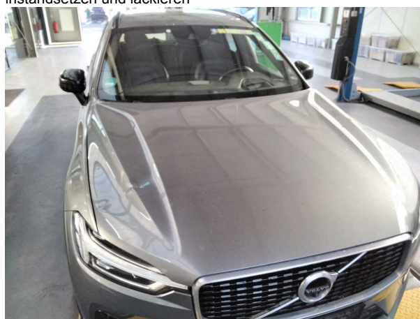
Beschädigung #13: Motorhaube: Motorhaube - verformt - erneuern
