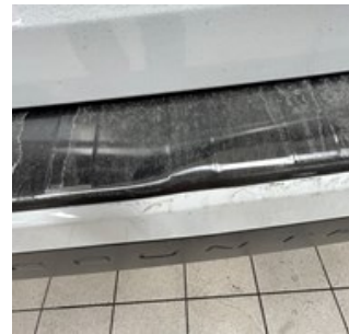
7.4.2 - Stötfångare bak Prydnads list lös. Ej original
