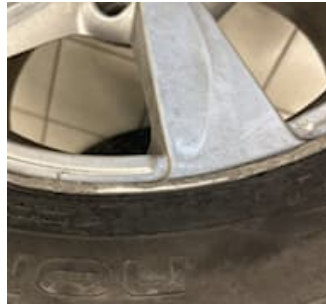
6.7.21 - Vinterfälg vänster bak :: Reparation alufälg (per skada om reparerbar)
