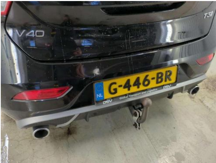
Bumper A: Kras(sen) Repair method: Herstellen en spuiten (compleet)
