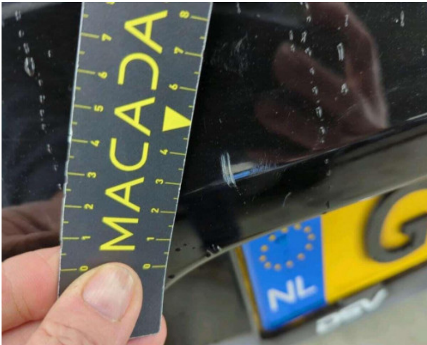
Bumper A: Kras(sen) Repair method: Herstellen en spuiten (compleet)
