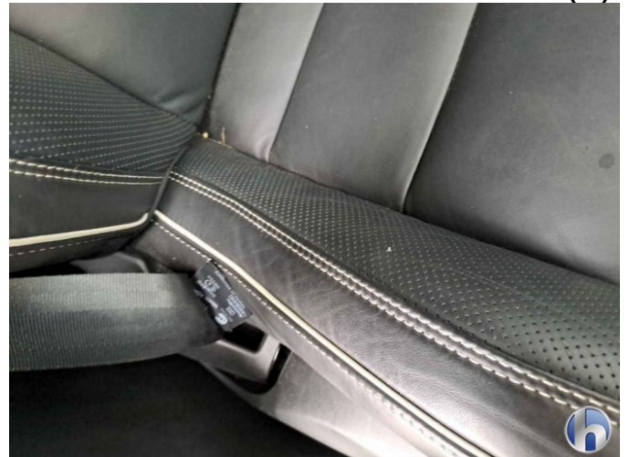
14. Sitz - Vorne - Rechts: Kissen Damaged
