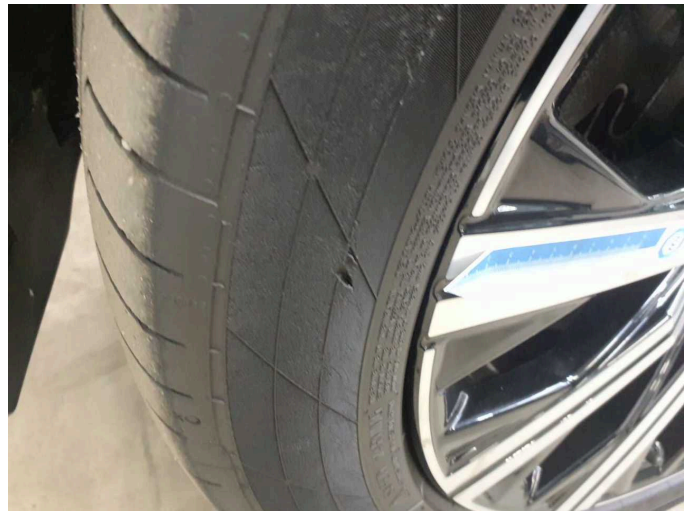
Damage 4: Wheel / tyres: Tyre - front left side (Flankenbeschädigung) - Damaged - Replace
