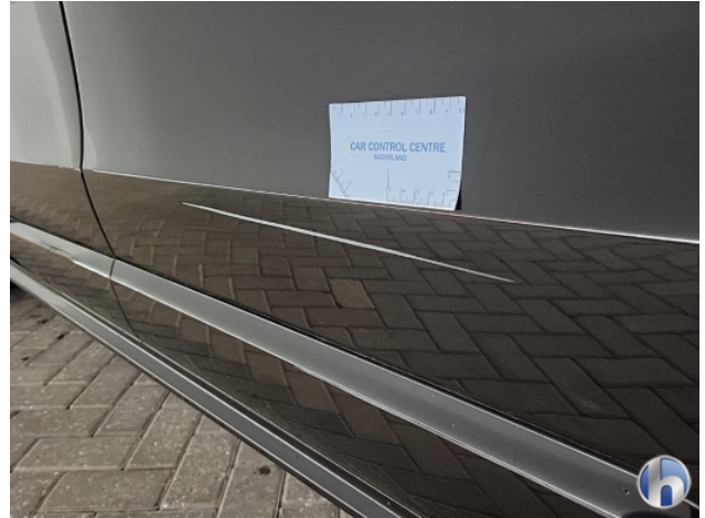
2. Portier achter - links Krassen - Spuiten
