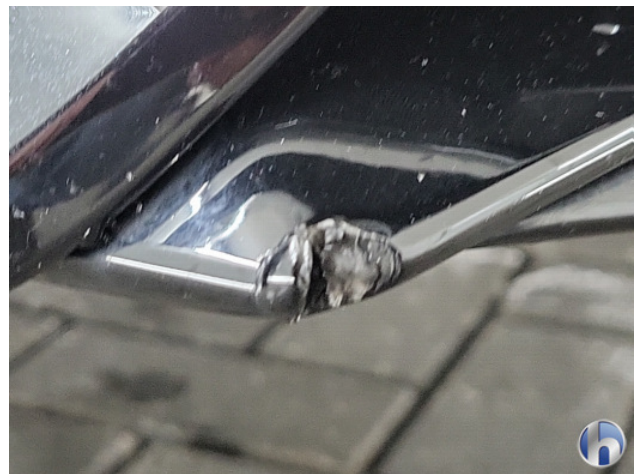
4. Voorspoiler Breuk / barst / scheur - Vernieuwen
