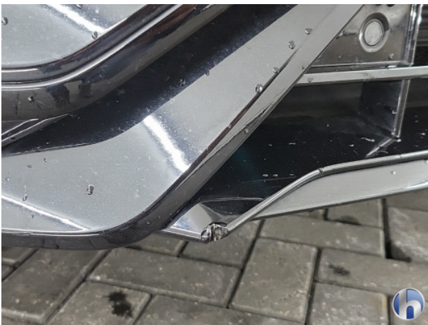
4. Voorspoiler Breuk / barst / scheur - Vernieuwen
