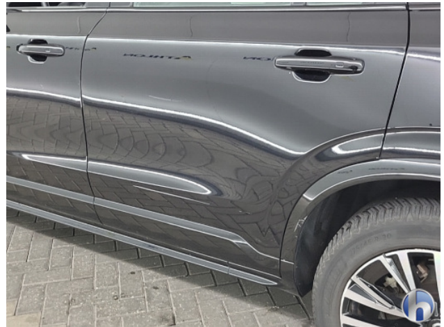
2. Portier achter - links Krassen - Spuiten
