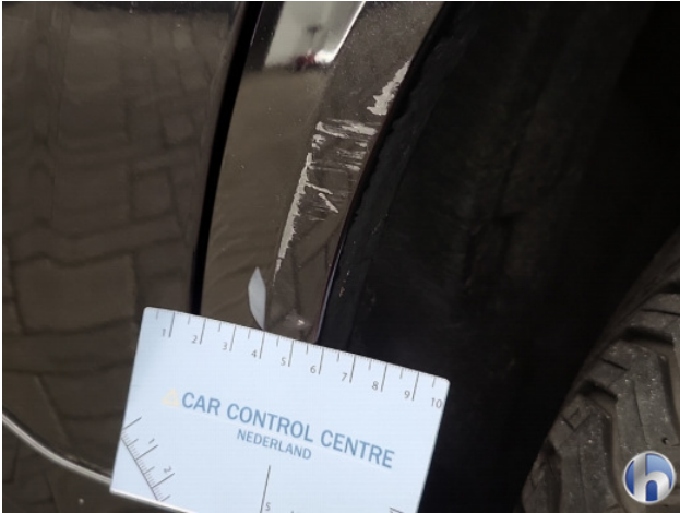
2. Portier achter - links Krassen - Spuiten
