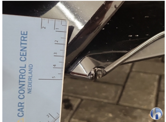
4. Voorspoiler Breuk / barst / scheur - Vernieuwen
