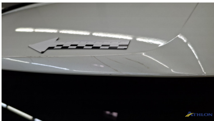
6. Heckklappe Kratzer Ab 60mm
