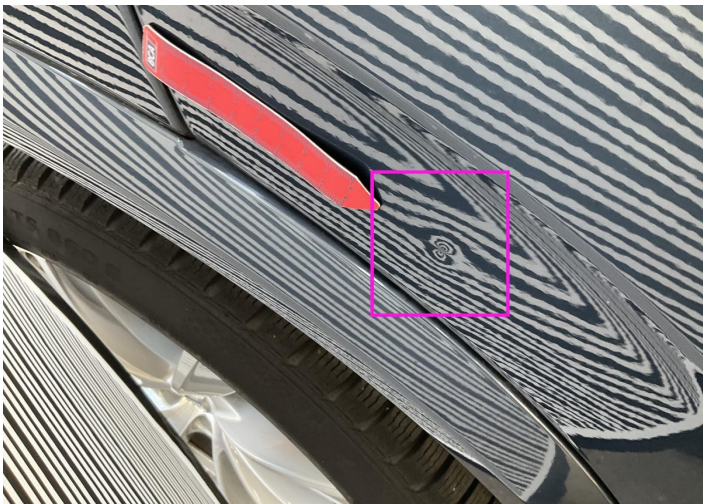
28. Door / Back Right Bodywork / Dent / Dent -
