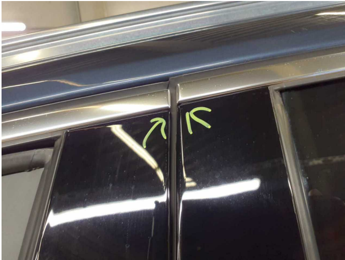
Damage 3: Door - front left side: Door - Malposition - Set / adjust
