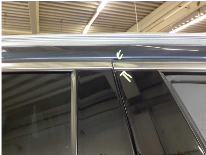
Damage 4: Door - front right side: Door - Malposition - Set / adjust
