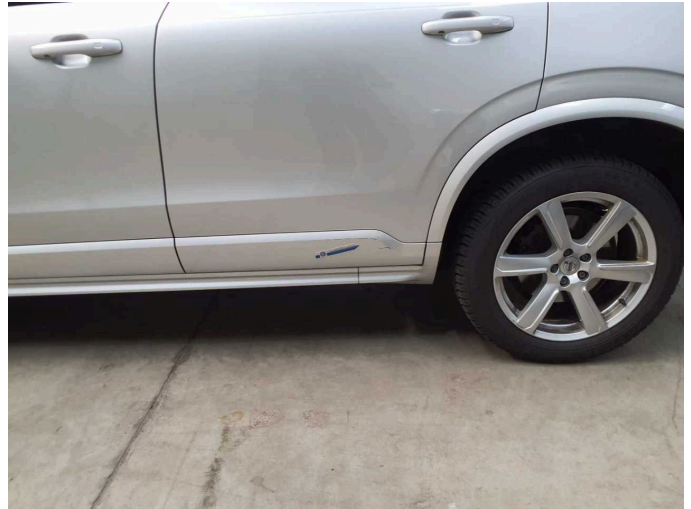
Damage 3: Door - rear left side: Door (Zierleiste) - Scratch(es) - Smart repair
