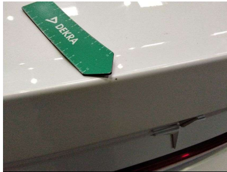
Heckklappe / Kofferraumtür / Hinten / Steinschlag
