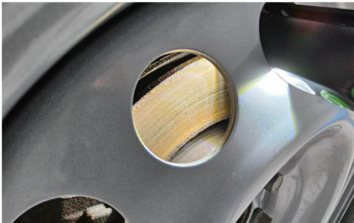
Bild 19 : Bremse stark korrodiert Unwucht bei Probefahrt
