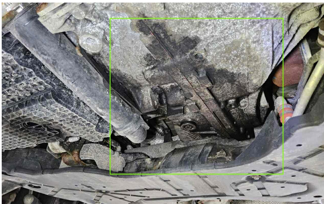
Bild 20 : Ölverlust am Motor und Getriebe
