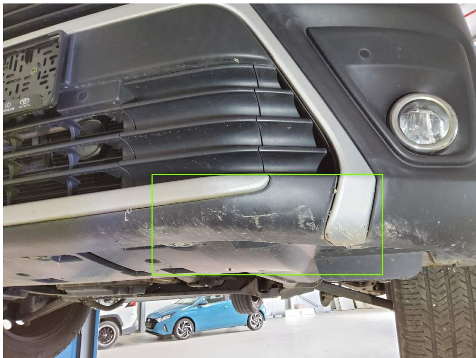
Bild 10 : Stoßfänger vorne unterhalb zerkratzt
