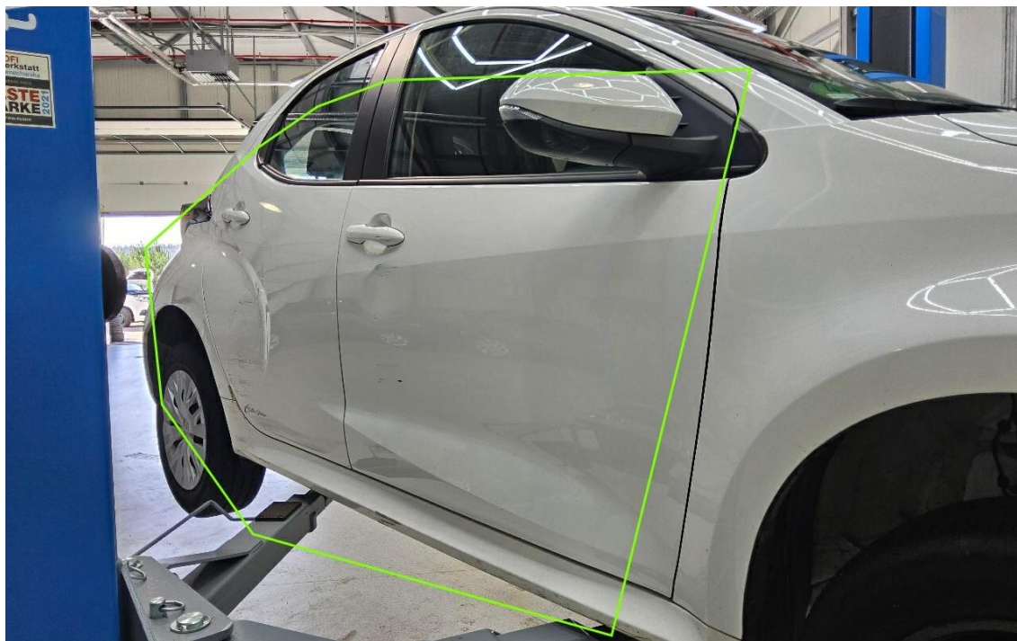
Bild 15 : Streifschaden rechte Seite
