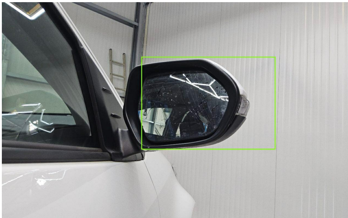
Bild 17 : Streifschaden rechte Seite
