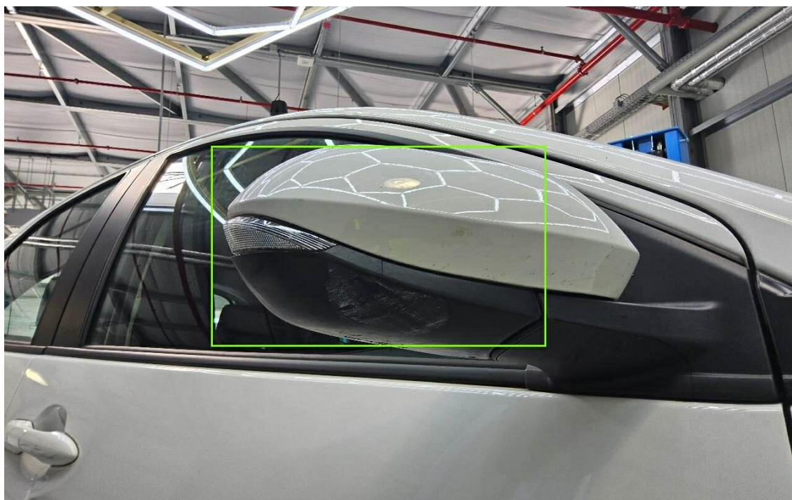
Bild 16 : Streifschaden rechte Seite
