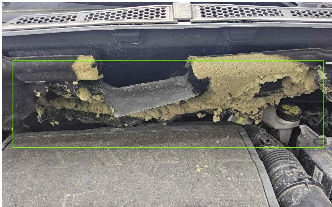
Bild 8 : Tierbissspuren Motorraum - Mehrkosten möglich
