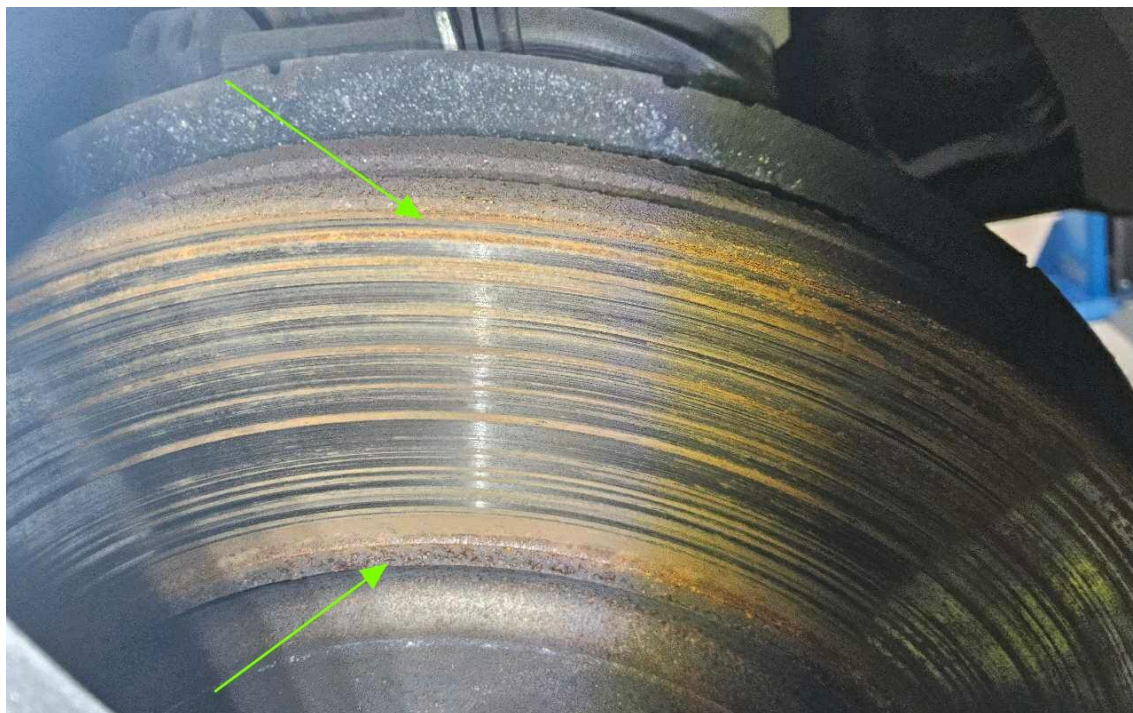
Bild 13 : Korrosionsbildung Bremse vorne - Freibremsen erforderlich
