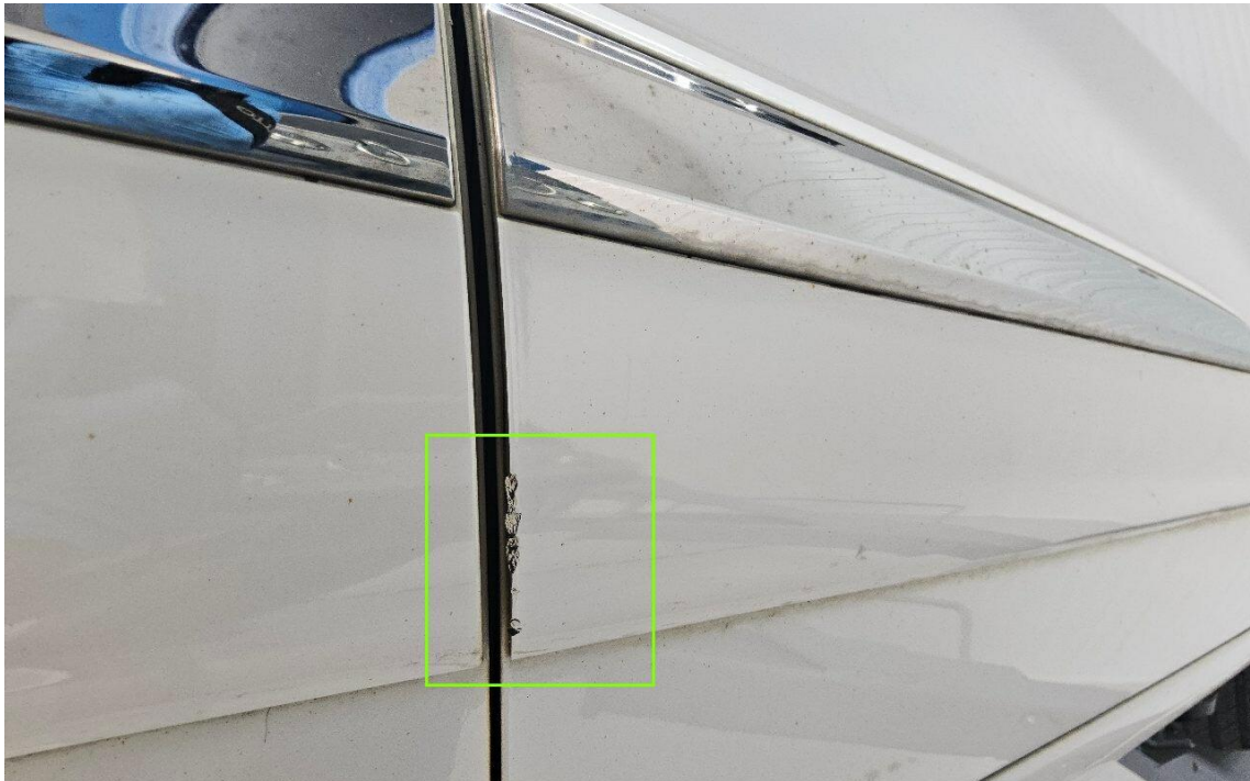
Bild 11 : Zierleiste Tür vorne rechts zerkratzt mit Materialabtrag
