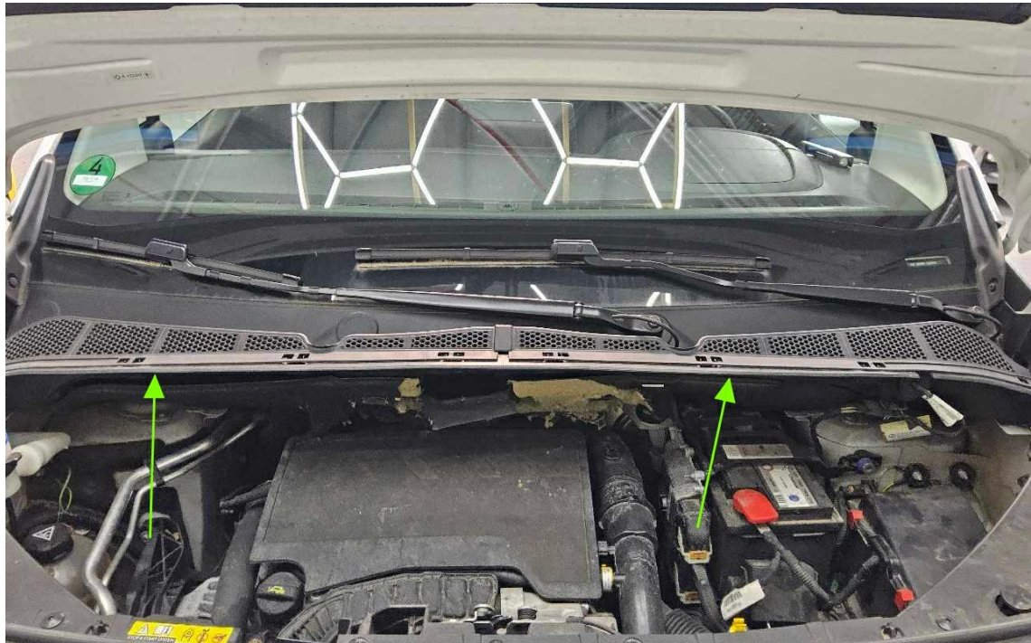
Bild 7 : Dichtung Spritzwand verschlissen
