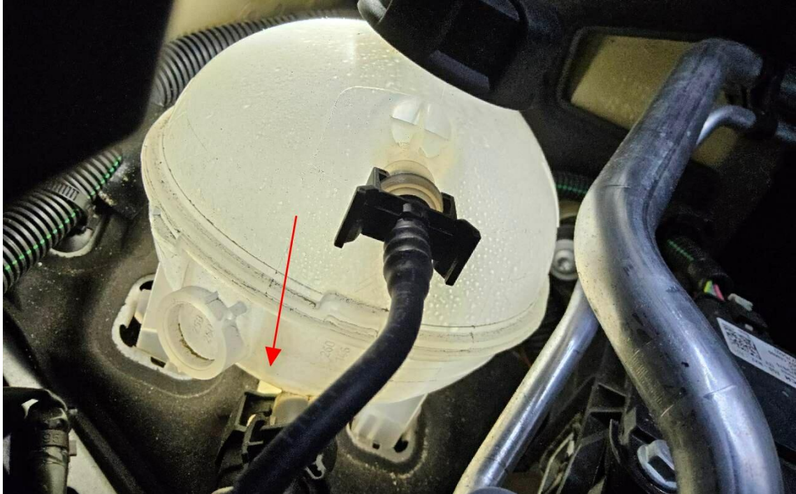
Bild 9 : Kühlmittelstand zu gering - Mehrkosten möglich
