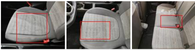
Revêtement assise ARD, Trou, Smart repair
