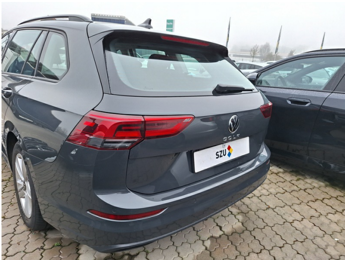
Stoßfänger hinten: Kratzer (Foto 21)
