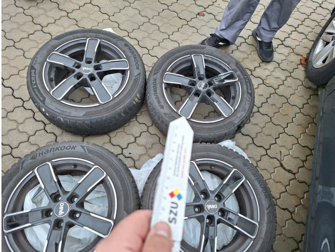
Zusatzfelge: verschrammt (Foto 9)
