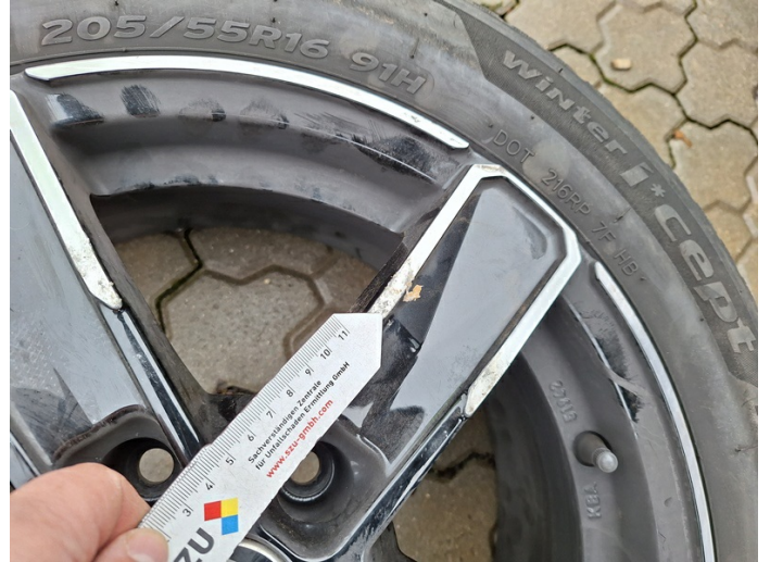
Zusatzfelge: verschrammt (Foto 10)
