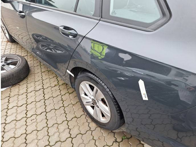
Seitenwand links: Kratzer (Foto 1)
