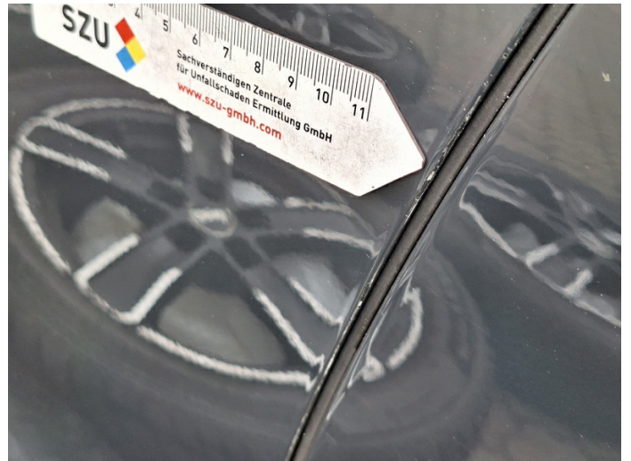
Tür vorne links: verschrammt (Foto 4)
