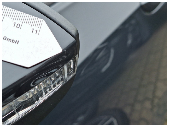
Außenspiegel links: Kratzer (Foto 14)
