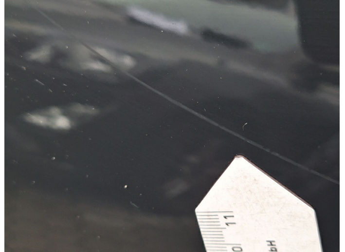
Seitenwand links: Kratzer (Foto 2)
