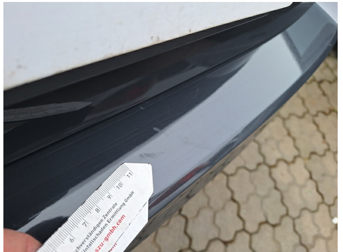
Stoßfänger hinten: Kratzer (Foto 22)
