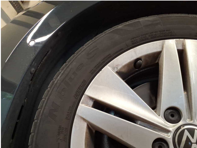
Beschädigung 5: Rad/Reifen: Leichtmetallfelge vorn links - Kratzer - Wertminderung
