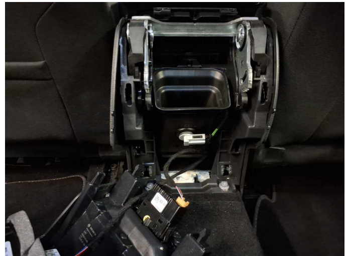
Beschädigung 7: Instrumententafel: Mittelkonsole hinten - gebrochen / gerissen - erneuern
