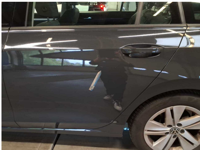
Beschädigung 8: Tür hinten links: Tür - Kratzer - lackieren
