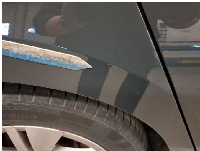
Beschädigung 4: Seitenwand rechts: Seitenwand - Kratzer - Smart Repair
