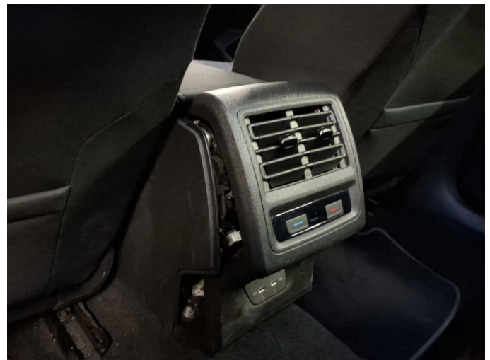
Beschädigung 7: Instrumententafel: Mittelkonsole hinten - gebrochen / gerissen - erneuern
