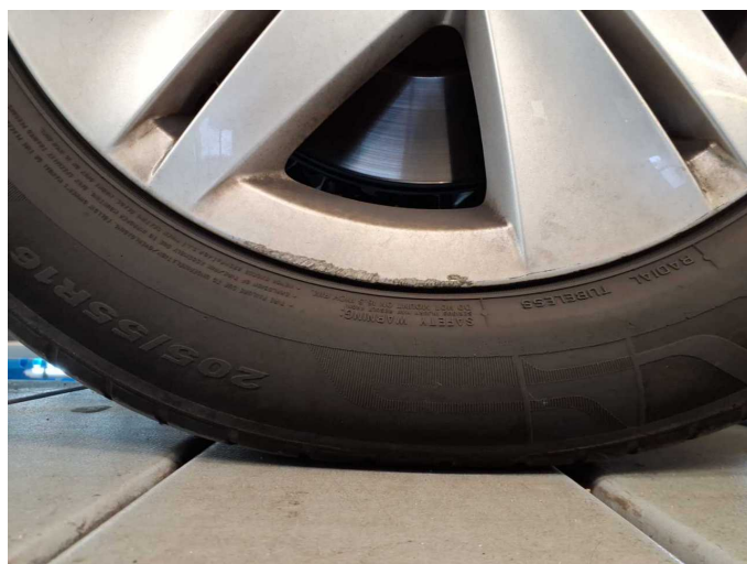
Beschädigung 5: Rad/Reifen: Leichtmetallfelge vorn links - Kratzer - Wertminderung
