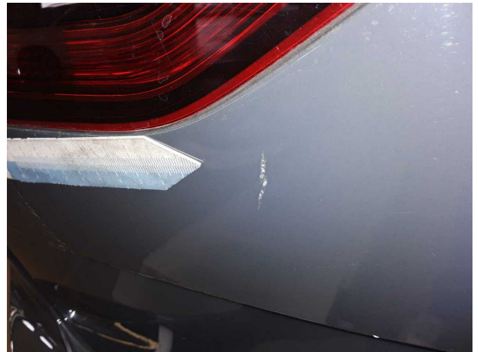
Beschädigung 7: Heckklappe/-tür: Heckklappe - Kratzer - lackieren
