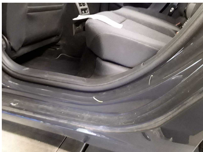
Beschädigung 2: Seitenwand links: Einstieg - Kratzer - Smart Repair
