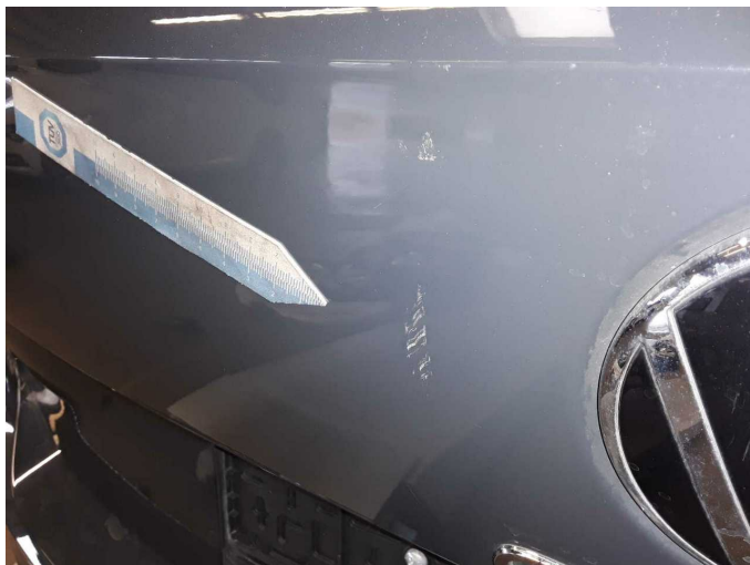
Beschädigung 7: Heckklappe/-tür: Heckklappe - Kratzer - lackieren
