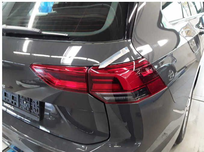
Beschädigung 3: Heckleuchte: Heckleuchte rechts - gebrochen / gerissen - erneuern
