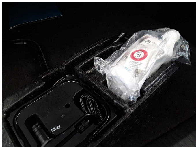
Beschädigung 1: Ausrüstung: Tirefit Füllmittel - abgelaufen - erneuern
