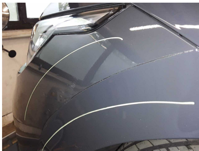
Beschädigung 6: Stossfänger vorn: Stossfänger vorn - Kratzer - lackieren
