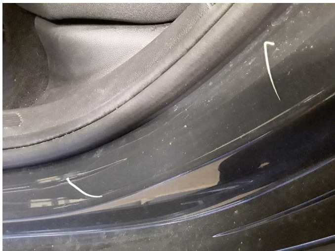
Beschädigung 2: Seitenwand links: Einstieg - Kratzer - Smart Repair
