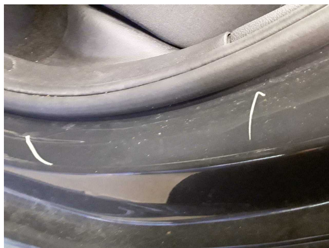
Beschädigung 2: Seitenwand links: Einstieg - Kratzer - Smart Repair
