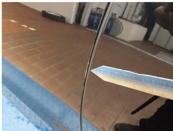
Beschädigung 4: Tür vorn links: Tür - verkratzt / verschürft - Smart Repair
