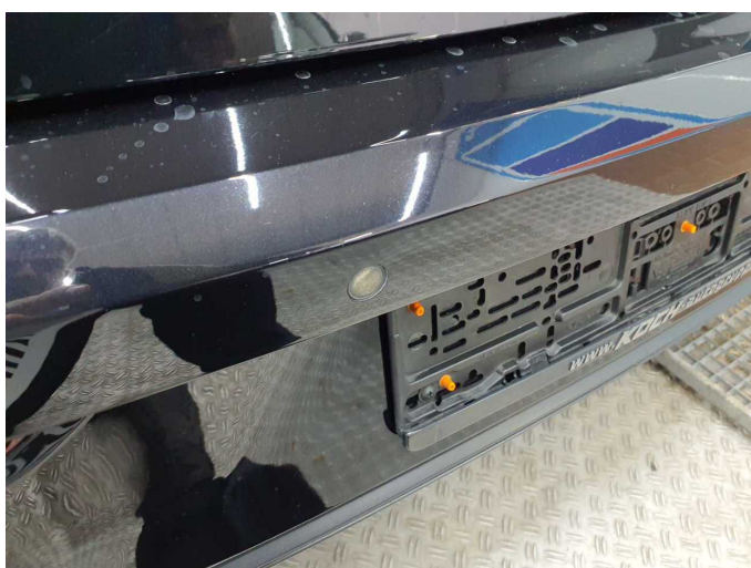
Beschädigung 2: elektronische Systeme: Einparkhilfe - Lackmangel - instandsetzen
