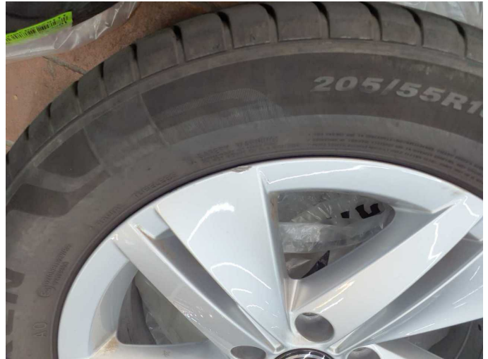
Beschädigung 5: 2.Radsatz: 2 Leichtmetallfelgen - verkratzt / verschürft - Wertminderung
