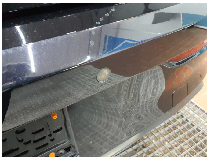
Beschädigung 2: elektronische Systeme: Einparkhilfe - Lackmangel - instandsetzen
