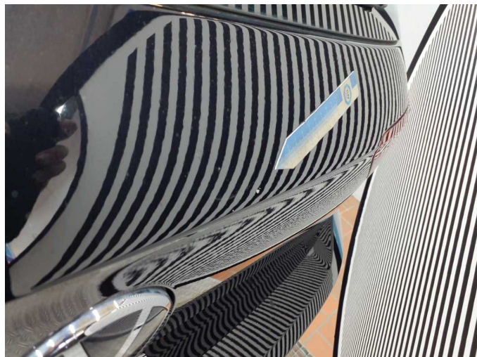
Beschädigung 3: Heckklappe/-tür: Heckklappe - verkratzt / verschürft - Smart Repair
