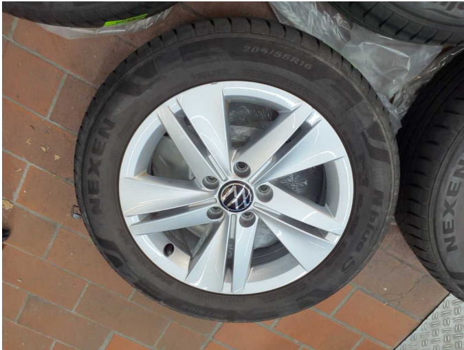
Beschädigung 5: 2.Radsatz: 2 Leichtmetallfelgen - verkratzt / verschürft - Wertminderung
