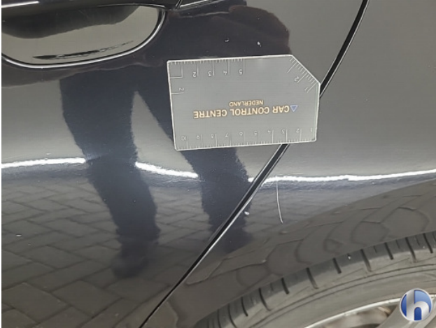
1. Portier achter - links Krassen - Spuiten
