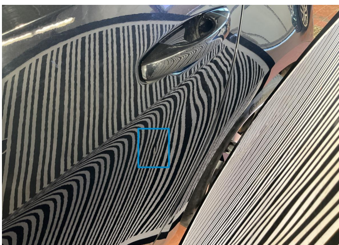
10. Door / Back Left Bodywork / Dent / Dent -
