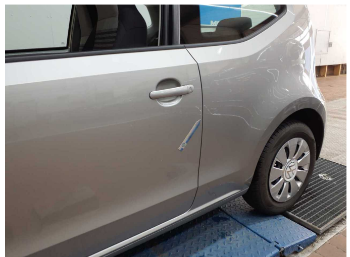
Beschädigung 3: Tür vom links: Türkante - Kratzer - Smart Repair
