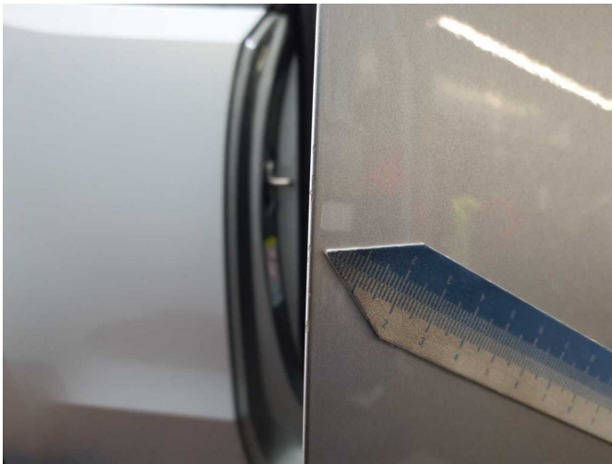
Beschädigung 4: Tür vorn rechts: Türkante - Kratzer - Smart Repair
