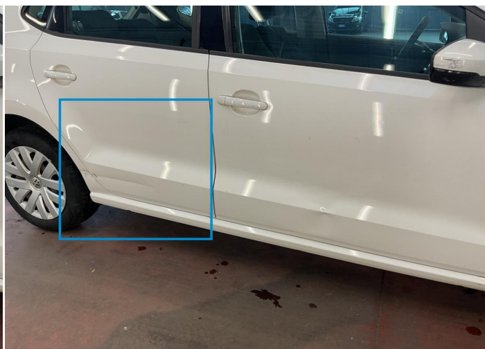
18. Door / Back Right Bodywork / Dent -
