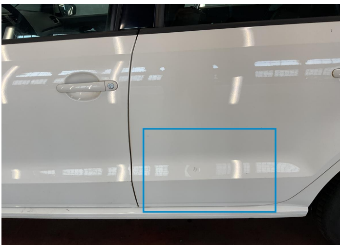
30. Door / Back Left Bodywork / Dent -
